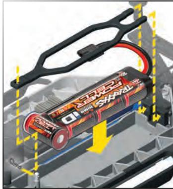
Setzen Sie die Batterie mit den Kabeln zur Rückseite des Modells ein. Setzen Sie die Laschen des Batterie-Niederhalters in die Schlitze auf der Rückseite der Halterung und setzen Sie anschließend den Batterie-Niederhalter über der Abtrennung ein. Sichern Sie den Batterie-Niederhalter mit einem Karosserie-Clip im Loch der Abtrennung. Schließen Sie den Batterie-Pack noch nicht an.
