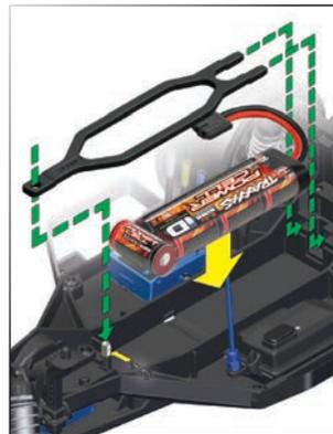
**Verwenden unterschiedlicher Batteriekonfigurationen**
