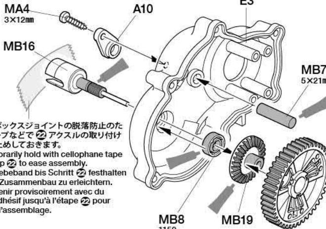
★ギヤボックスジョイントの脱落防止のためにテープなどで②アクスルの取り付けまで仮止めしておきます。
