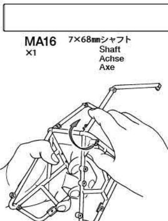
★ロールケージは図のように回転させて左右をねじ込みます。
