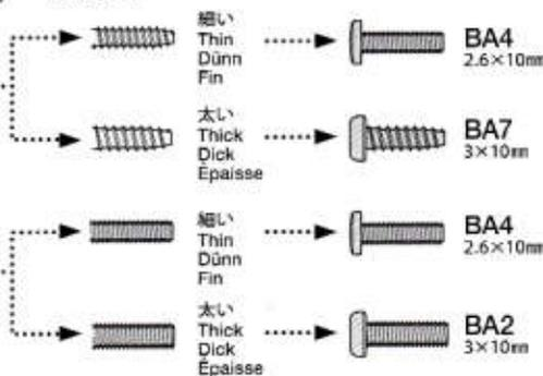
★使用するサーボの取り付け部に合わせて選びます。
