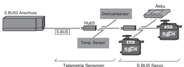
Die Servosignale am normalen Servoausgang (Kanal 1...4) und am S.BUS Ausgang stehen gleichzeitig zur Verfügung. Um z.B. ein V-Kabel zu ersetzen, kann 1 Servo am normalen Ausgang angeschlossen werden, das zweite Servo am S.BUS Anschluss.
