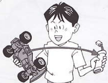
⑥ 走らせたあとは、かならずバッテリーをはずしておきましょう。
