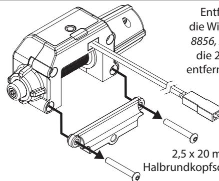
Entfernen Sie die Halterung für die Winde von der Winde (Teilnr. 8856, separat verkauft), indem Sie die 2,5 x 20 mm-Kopfschrauben entfernen. Die Schrauben werden nicht mehr benötigt.
