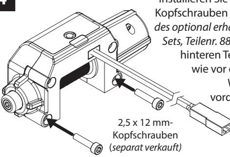
Installieren Sie die 2,5 x 12 mm-Kopfschrauben (im Lieferumfang des optional erhältlichen Winden-Sets, Teilnr. 8855, enthalten) im hinteren Teil des Gehäuses, wie vor der Montage der Winde am neuen vorderen Stoßfänger angezeigt.
