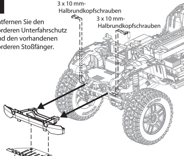
Entfernen Sie den vorderen Unterfahrerschutz und den vorhandenen vorderen Stoßfänger.
