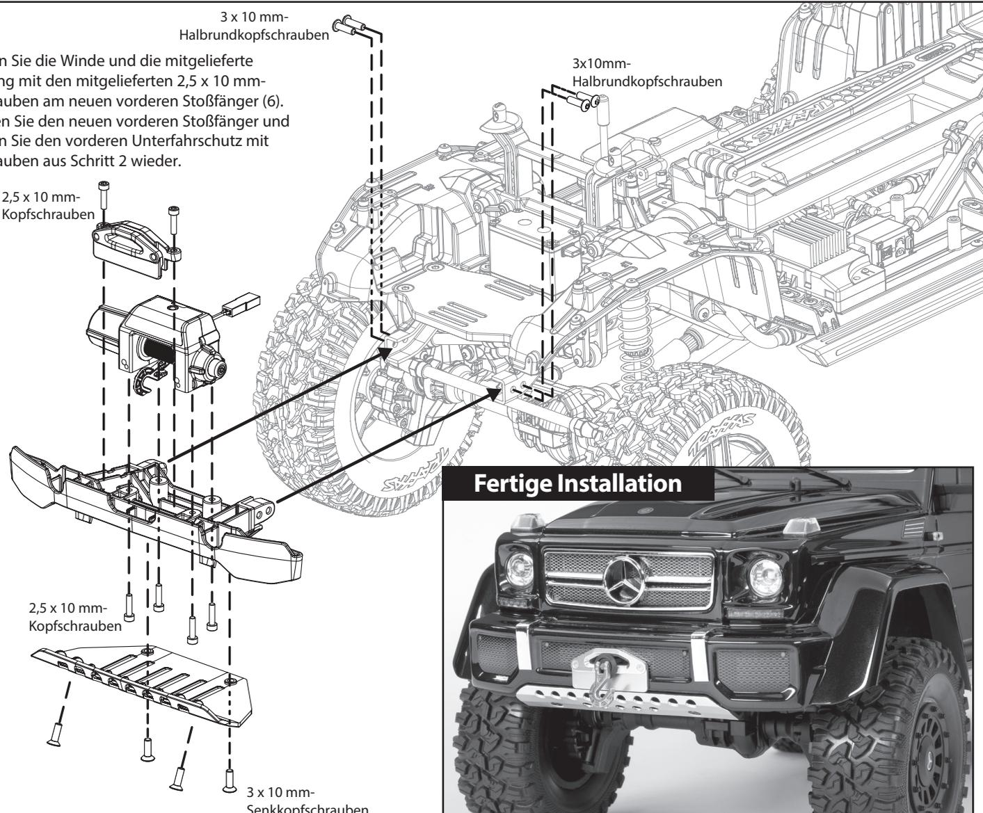
Befestigen Sie die Winde und die mitgelieferte Seilführung mit den mitgelieferten 2,5 x 10 mm-Kopfschrauben am neuen vorderen Stoßfänger (6). Installieren Sie den neuen vorderen Stoßfänger und montieren Sie den vorderen Unterfahrerschutz mit den Schrauben aus Schritt 2 wieder.
